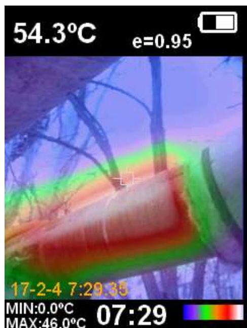
Рис. 2. Участок тепловой сети с повреждением
