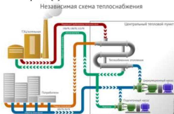
Рис. 1 Схема независимой системы теплоснабжения
